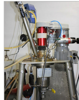
Reaktorsystem zur Herstellung von Dilactid [Fraunhofer IAP]
