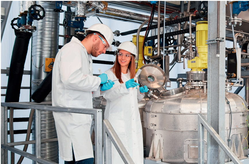
Bild 4. Im Großtechnikum des Fraunhofer IVV wurden mehrere 100 kg Rezyklat durch physikalisches lösemittelbasiertes Recycling produziert. © Fraunhofer IVV
