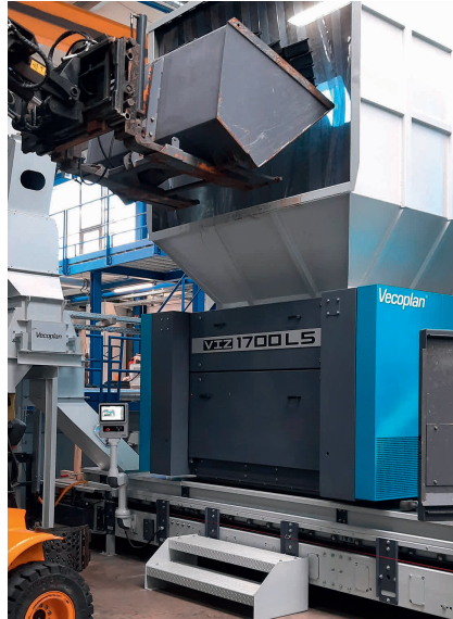
Bild 3. Beschickung eines leistungsfähigen Zerkleinerers im Technologiezentrum von Vecoplan. © Vecoplan
