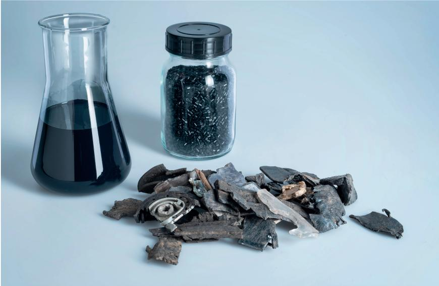
**Bild 2.** im Vordergrund: geschreddertes Inputmaterial, hinten links: Polymer in Lösung, hinten rechts: compoundiertes Granulat des Post-Consumer-Rezyklats (PCR). © Audi AG
